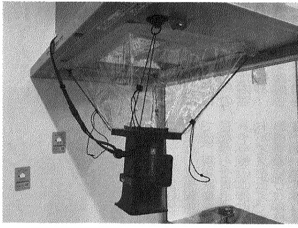
使用方はレンジフードにマグネット測定器を吊るし、ピンケーブルのフードをマグネットやテープで取り付けるだけ。設置時間は約3分。測定結果はスマートフォン専用のアプリを用いて確認が可能。画面の指示通りに情報を入力すると、C値や通気率などが表示されるため「簡単に測定が可能」という。今後気密測定に取り組みたいビルダーや全棟検査を行なうビルダーに提案していく構えだ。また、リノベーションで断熱・気密改修を行なう際にも、気密施工をしながら測定して効果を確認することも可能。「より積極的に気密の取り組みが可能」という。
